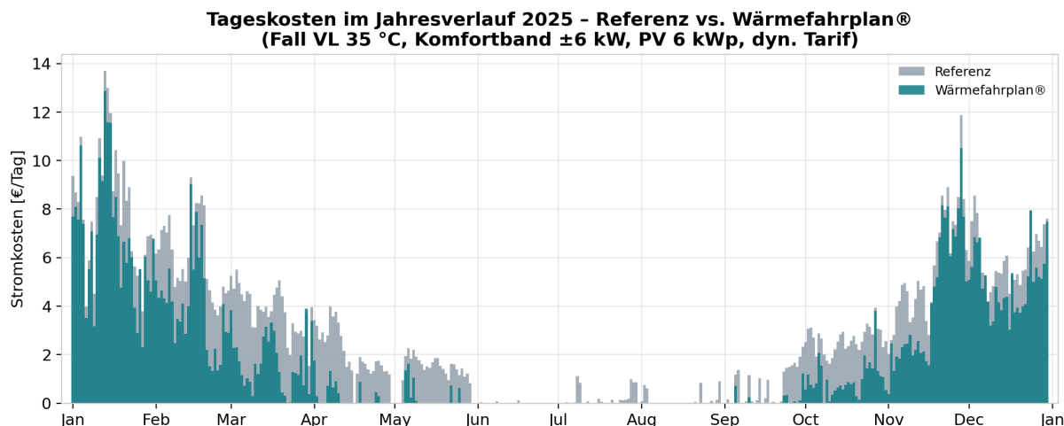
Abbildung 11: Tageskosten aller 365 Tage des Jahres 2025 – Referenz (grau) vs. Wärmefahrplan® (dunkel), Fall VL 35 °C, ±6 kW, PV 6 kWp, dyn. Tarif.
