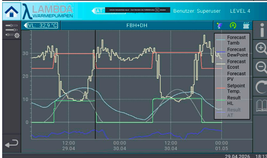
Abb. 2: Wärmefahrplan mit Witterungseinfluss, dynamische Stromtarife, und PV
